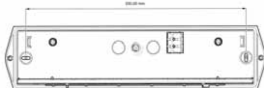
Distances de perçage KWI mur / plafond
